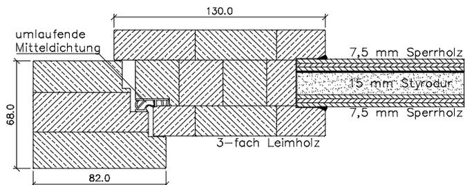
Rahmen aus 3-fach Leimholz 68 x 130 mm stark mit umlaufender Mitteldichtung, Sockelhöhe 130 mm
