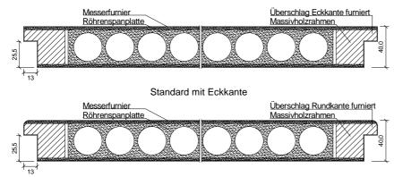
Türstärke ca. 40 mm, Rahmen Massivholz mit Band- und Schlossverstärkung, unten als 2. Riegel zusätzlich Vollspanstreifen, Mittellage Röhrenspanplatte, Aufbau 5-fach, Deck *längs*- und/oder *querfurniert*, Falz 3-seitig *furniert*, Überschlag eckig
