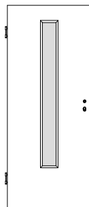
VN/K3-LA2 mit Alueinlage, Falzdichtung, Schall-Ex
